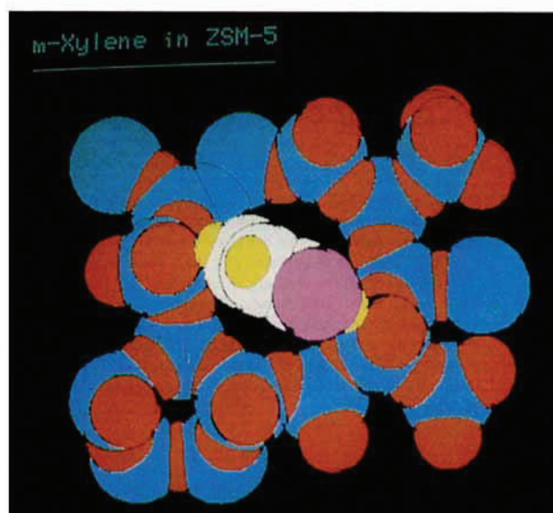
Abb. 6. Oben: Mechanismus der protonenkatalysierten Alkylierung von Aromaten am Beispiel der Synthese von Ethylbenzol an ZSM-5. Mitte und unten: Es ist leichter für para -Xylol als für meta -Xylol, durch einen ZSM-5-Katalysator zu diffundieren.
